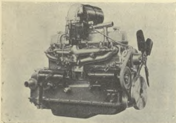
6-cylindrowy, górnozaworowy silnik Fiata mod. „1500”.
