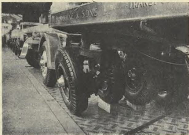
Przyczepka 8-kołowa Dyson. Każda para kół, stanowiących jedną całość, jest oddzielnie zawieszona i uresorowana.
