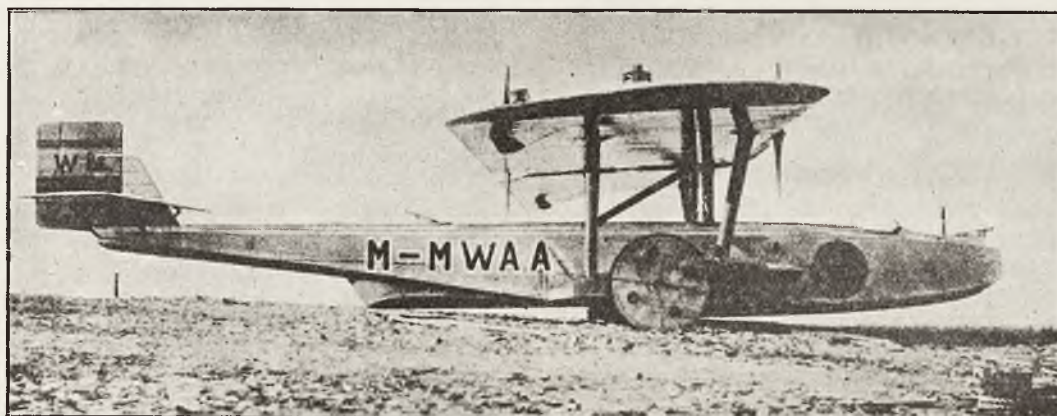
Wodnopłatec Dornier - Wal typu łodzi latającej, przeznaczony do wyprawy R. Amundsena i zaopatrzonej w koła do lądowania.
