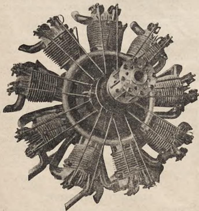
Silnik Salmson AB. 9. 230 MK. Chłodzenie powietrzem.
