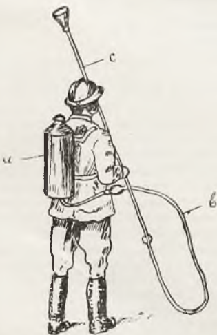
SONIECKI ROZPYLACZ IPERYTOWY TORNISTROWY a - ZBIORNIK IPERYTU b - WAZ RURY WYPUSKOWEJ c - RURA WYPUSKOWA Z ROZPYLACZEM.
