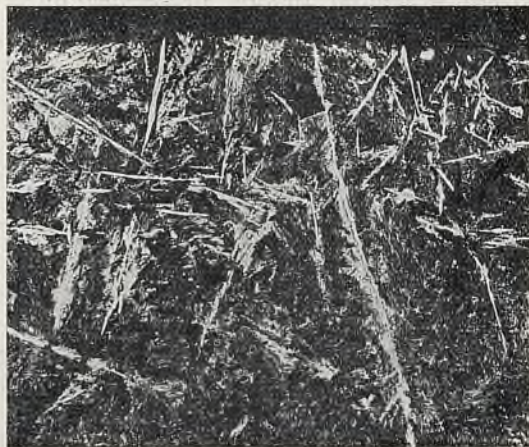
Fot. 5. Pow. 100 \times , tr. kw. pikryn., materiał u powierzchni blachy od strony wewnętrznej kotła, igły cementytu na tle perlitu.
