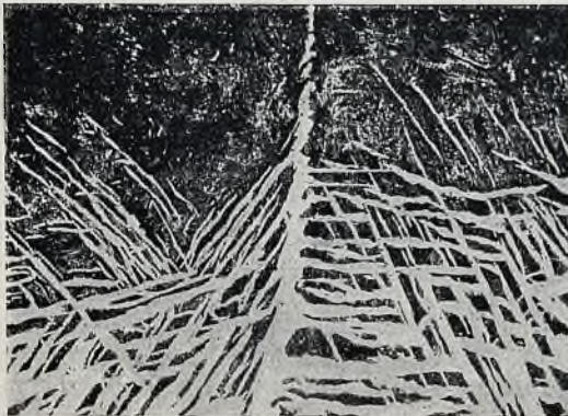
Fot. 7. Pow. 100 \times , tr. kw. pikryn., przejście od warstwy nacementowanej ku wnętrzu blachy, budowa Widmannstätten'a — skutek silnego przegrzania.
