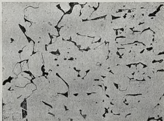
Fot. 3. Pow. 100x, traw. kwasem pikrynowym materiał wnętrza blachy kotła destylacyjnego, na tle ferrytu ciemne pola perlitu.
