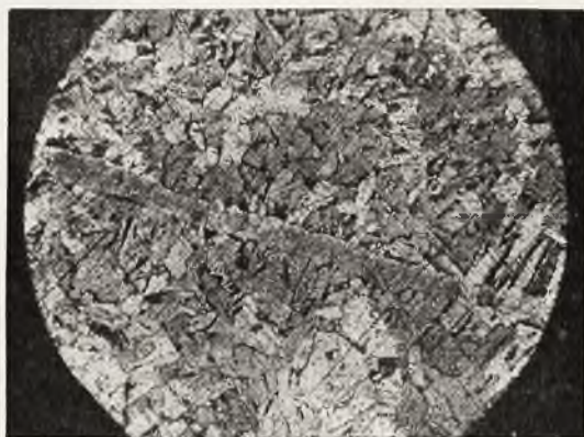
Rys. 9 Butla do sprężonego powietrza Budowa materiału. Powiększenie 1:100.
