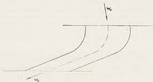
Rys. 1. Schemat kanału łopatkowego.
