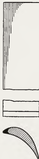
Rys. 11. Łopatką turbinową hartowaną powierzchniowo. (Według Brown Boveri Mitteilungen 1934, str. 29).
