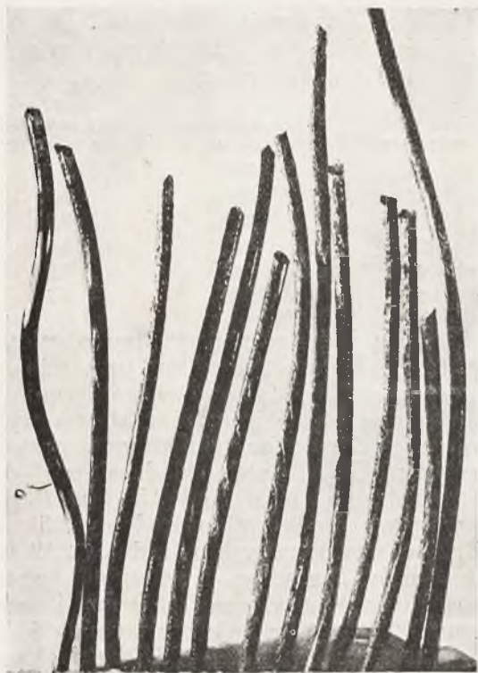
Rys. 7. Druty górnej warstwy. Starcia i korozje. o — drut wewnętrznej warstwy.
