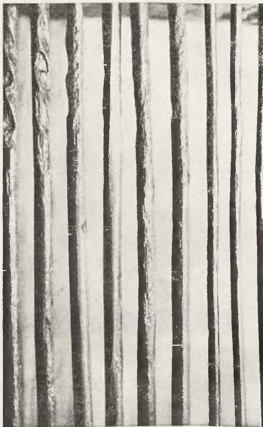
Rys. 6. Starcia i korozje drutów w trzech warstwach splotu.
