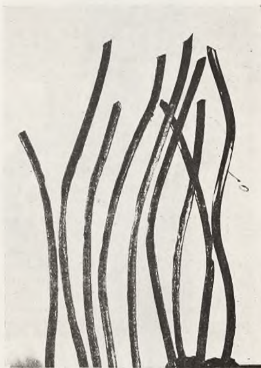
Rys. 8. Druty średniej warstwy. Starcia i korozje. o — drut wewnętrznej warstwy.
