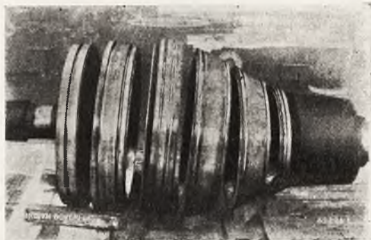
Rys. 20. Elementy nowoczesnego wirnika turbinowego B. B. C. o konstrukcji spawanej — w widoku, przed spawaniem. Na zdjęciu widoczne rowki odciążające w pobliżu przyszłych szwów. (Według Brown Boveri Mitteilugen 1937, str. 318).
