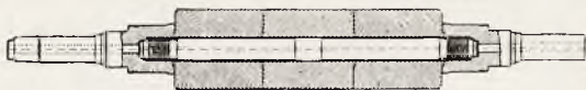
Rys. 22. Wirnik turboprądnicy syst. Brown Boveri, składany z części. (Według Brown Boveri Mitteilungen 1936, str. 15.)
