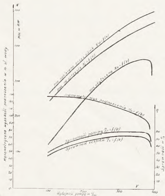
Rys. 9. Charakterystyka pompy przy n \approx 980 \text{ obr/min} .
