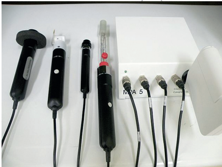
Rycina 6. Urządzenie MPA 5® wraz z sondami do pomiaru parametrów czynnościowych skóry (źródło: dokumentacja własna)
