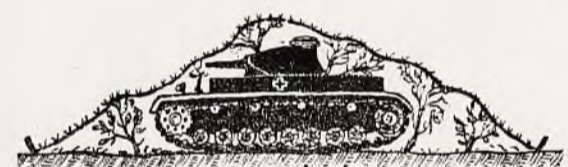
Rys. 24. Zmiana kształtów czołga przez pokrycie maską
