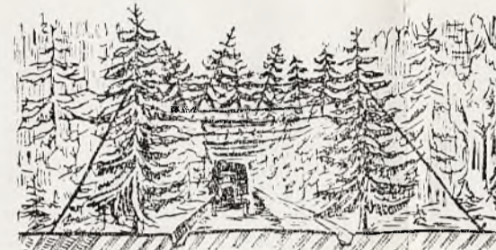
Rys. 13. Szosa przez las zamaskowana przez wierzchołki drzew umocowanych na drutach rozpiętych między drzewami
