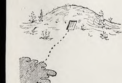
Rys. 33. Wejście do pozornego schronu, pozorowane przez papę. Nie zapominać o pozornej ścieżce do schronu
