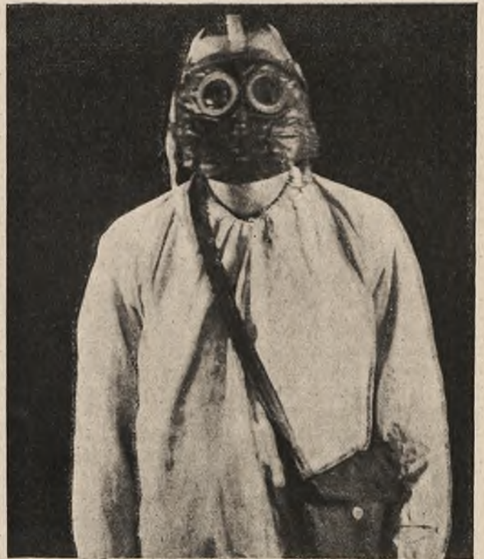
Rys. 2. Maski z okularami: maska rosyjska „Zieliński — Kumant” (okulary osobno), maska francuska M 2
