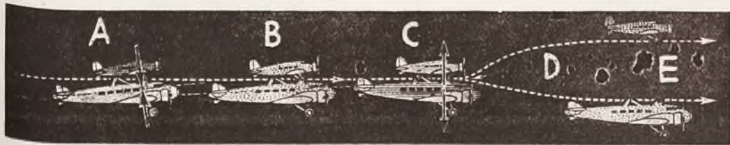
A. Samoloty mają tendencję dociskania jeden do drugiego. Szybkość 80 km/godz. Samoloty wznoszą się. B. Samoloty zachowują się obojętnie jeden względem drugiego. Szybkość 110 km/godz. Samoloty zachowują swoją wysokość. C. Samoloty dążą do oddzielenia się. Szybkość 170 km/godz. D. Samoloty odłączyły się jeden od drugiego. Szybkość około 200 km/godz. E. Każdy samolot podąża swoją drogą.
