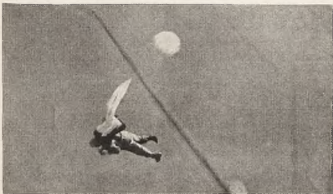
Mały spadochron, tzw. „pilocik“, wyciąga spadochron właściwy
