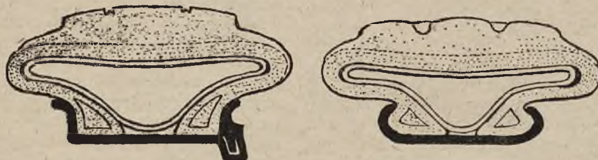
Na lewo: opona bez obrzeżyń po wypuszczeniu z niej powietrza. Na prawo: opona również bez powietrza, naciągnięta na zwykłą obręcz. Przy jeździe w tej pozycji może wyniknąć poważna szkoda dla opony.
