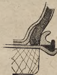
Jedna z wielu postaci odpinalnych obręczy w przekroju. Po usunięciu zacieniowanej części można z najmniejszym wysiłkiem usunąć oponę wraz z częścią obręczy.
