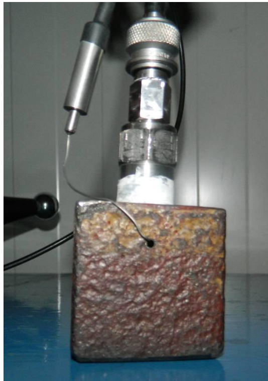
Rys. 7. Widok przetwornika typu A zamontowanego w adapterze [1]
