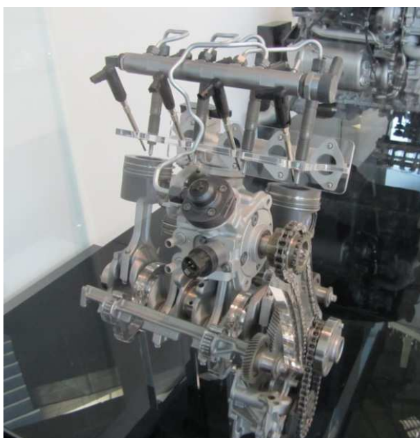
Rys. 6. Układ common rail [16]
