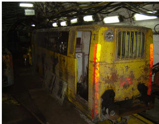
Rys. 15. Lokomotywa Lds-100K-EMA w podziemnym wyrobisku górniczym [11]
