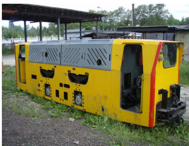
Rys. 9. Lokomotywa Lds-100 wyposażona w silnik SW 400 [11]
