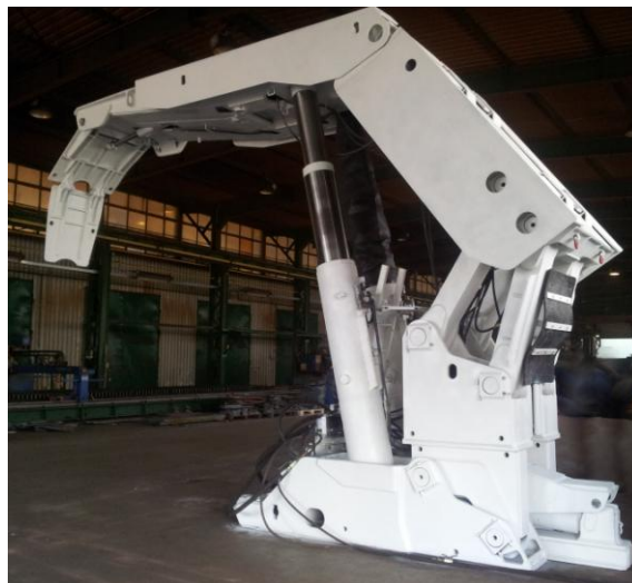
Rys. 16. Prototyp sekcji obudowy HYDROMEL-29/46-POz [1]
