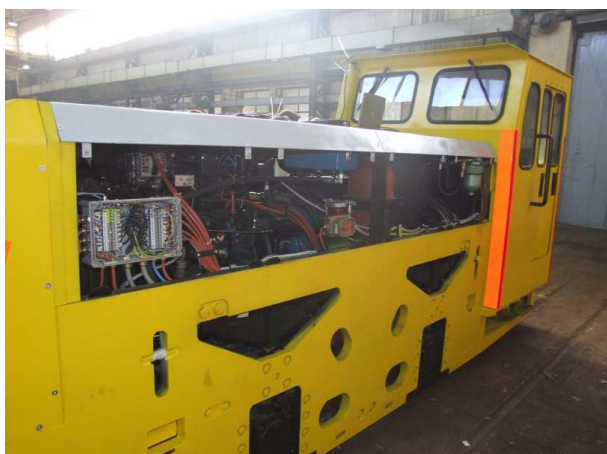
Rys. 11. Lokomotywa WLP-50EM napędzana silnikiem 4CT107 [11]
