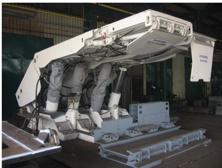
Rys. 5. Prototypy sekcji obudowy HYDROMEL-16/35-POz i HYDROMEL-16/35-POz/BSN w siedzibie Przedsiębiorstwa HYDROMEL S.A. [1]
