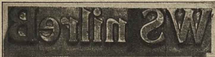
Czcionki zniszczone ziarenkami piasku. Wgłębienia w czcionkach posiadają ostre brzegi. (2-krotne powiększenie).
