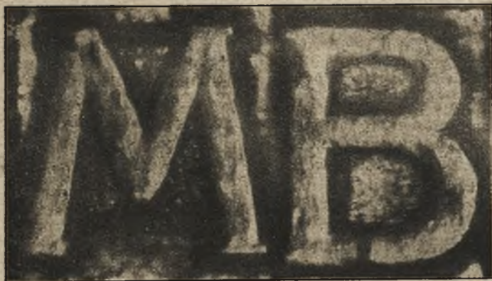
Czcionki wykazujące blizny, spowodowane guzkami w papierze. (6-krotne powiększenie)
