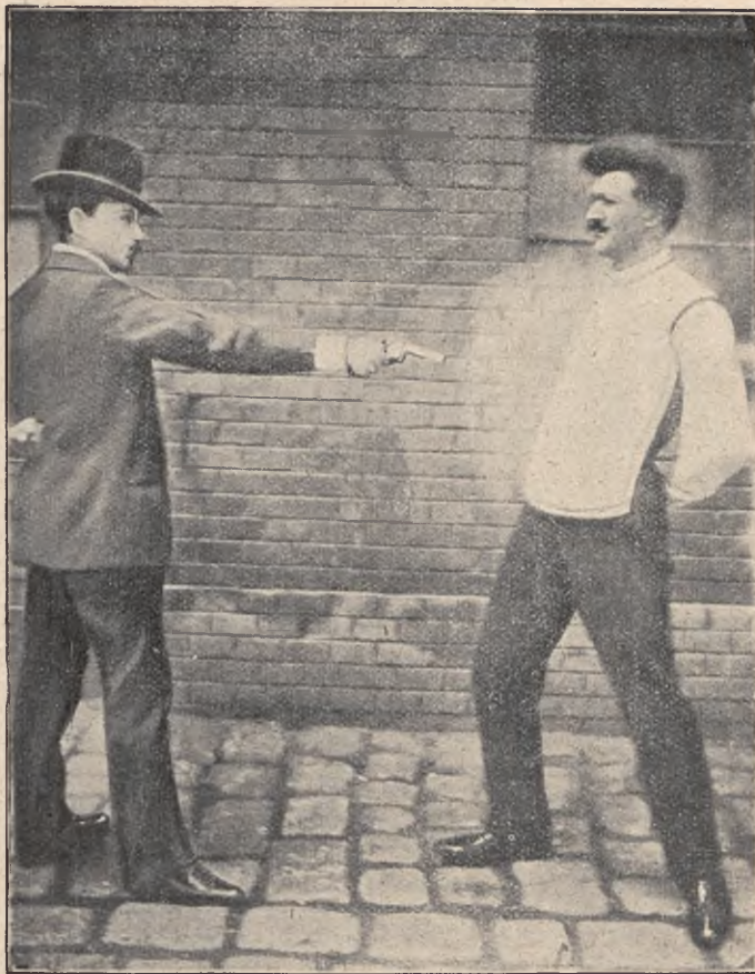
Strzał do pancerza kulotrwałego systemu Szczepanika.
