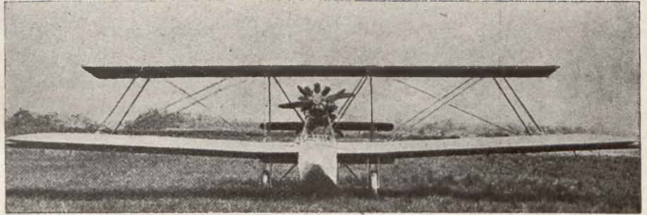
Dwupłatowiec „Caproni“ o 2-ech silnikach „Gnome-Rhône-Jupiter“ po 480 MK, chłodzonych powietrzem.
