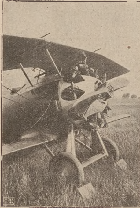
Okapturzenie' gwiazdzistego silnika lotniczego chłodzonego powietrzem w celu zredukowania do minimum jego oporu w powietrzu.
