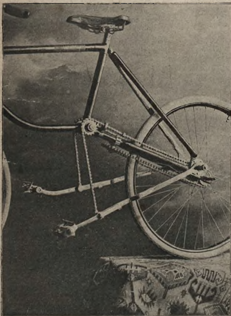
Rower dźwignią: Ulepszony mechanizm roweru dźwigniowego.
