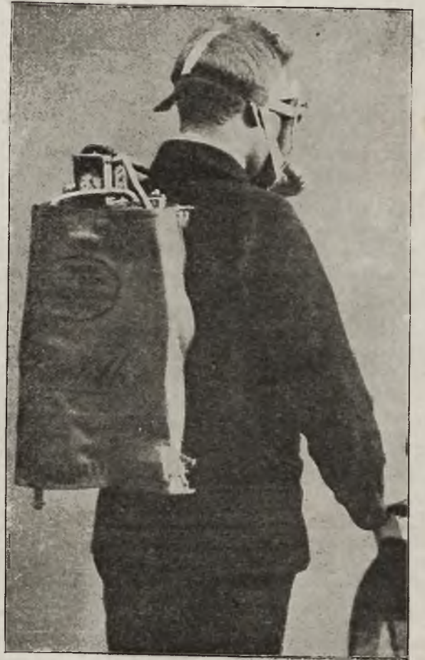
Doniosły wynalazek: Aparat wynaleziony przez inżyniera Suessa, a umożliwiający górnikom dłuższy pobyt w przestrzeni wypełnionej trującymi gazami.
