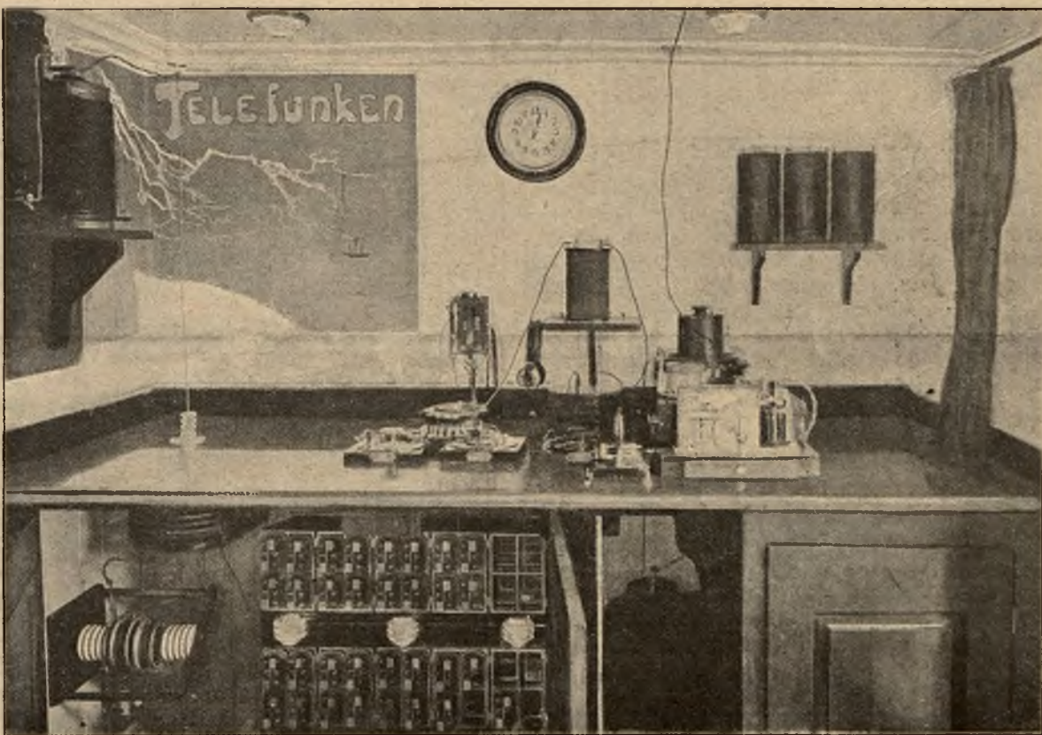
Redakcja na okręcie: Stacja telegrafu bez drutu na okręcie, służąca do odbierania depech dla wydawnictwa dziennika okrętowego.
