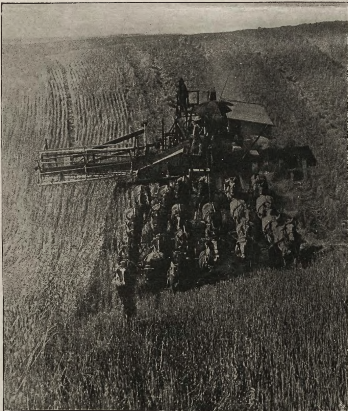
Żniwa w Ameryce: Maszyna, która zboże rźnie, wiąże w snopy, młóci i czyści odrazu, w ruchu.
