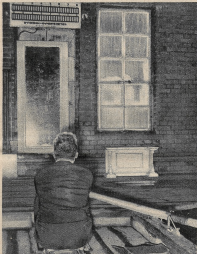
Wynalazca „synchronicznego dynamometru“ na aparacie w basenie wiosłarskim. U góry nad lustrem widoczna skala dynamometru, która pokazuje siłę uderzenia.
