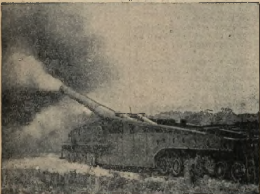
W ostatnich manewrach amerykańskich wypróbowano ogromne działo kolejowe. Posiada ono kaliber 35 cm., a pociski o wadze 1500 kg. niesie na odległość 25 mil ang.
