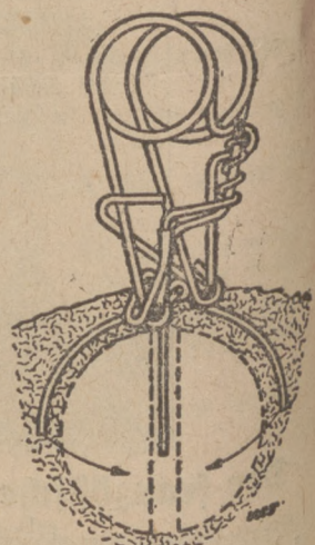
Wühlmausfalle fänglich eingebaut.
