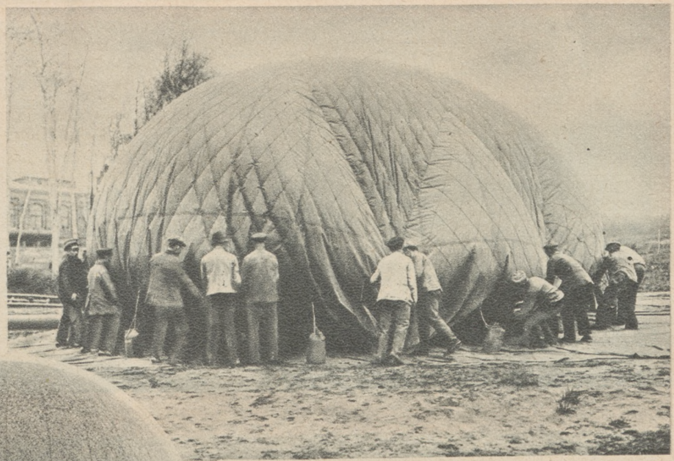
Während der Füllung wird das Netz des Ballons mit Sandsäcken belastet Phot. Stöder
