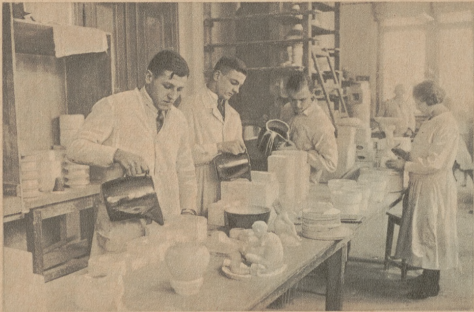
Das Gießen von Keramikfiguren in Gipsformen Eberl
