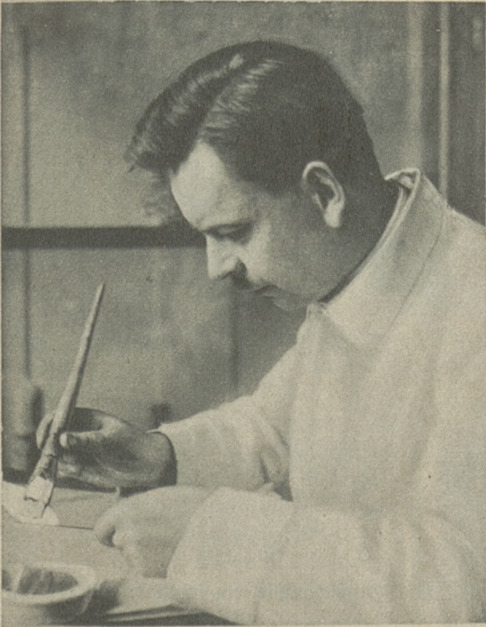
Eine Glasplatte wird mit weißer Aquarellfarbe gleichmäßig gestrichen
