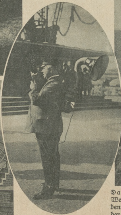
Im Oval: Aus der großen deutschen Funkausstellung in Berlin. Ein Kommando-Apparat für weite Schallwirkung. Der Lautsprecher auf dem Rücken des Trägers gibt die in das Mikrophon gesprochenen Worte weithin hörbar wieder Sennede
