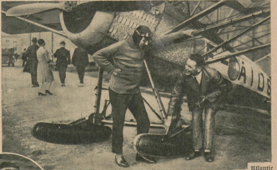
Um beim Landen der Flugzeuge den Anprall auf dem Erdboden zu mindern, hat man in Frankreich Versuche mit Raupengleitern an Stelle der Räder gemacht, die auf federnden Gelenken befestigt sind.
