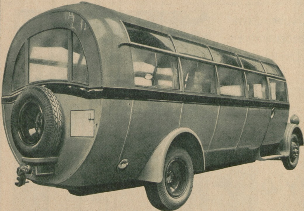
Zwei interessante Wagen, der Riese und der Zwerg, auf der Großen internationalen Automobilausstellung in Berlin, die eine ungeheure Besucherzahl aus dem In- und Auslande aufzuweisen hatte. — Bild links: Reise-Omnibus in Sonnenform. Die Sonnenform begünstigt das Problem der Luftverdrängung. Eine größere Geschwindigkeit soll somit zu erzielen sein. — Bild rechts: Das „Wochenend“-Motorrad mit Beiwagen und Anhänger, in dem Zelt, Faltboot usw. mitgeführt werden können. — Presse-Photo
