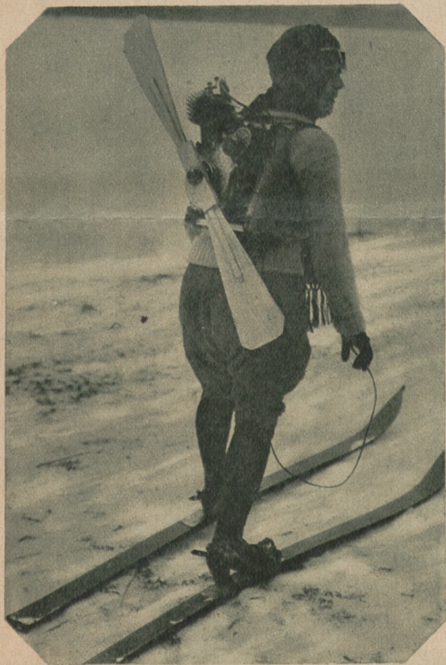
Zwei interessante Versuche, sich auf Schneeschuhen mit Motorenkraft fortzubewegen. Links: Ein kleiner Motor mit Propellerantrieb wird auf dem Rücken getragen. Oben: Der Motor, an dem ein Sitz angebracht ist, läuft auf einer Schiene zwischen den beiden angeschnallten Schneeschuhen
