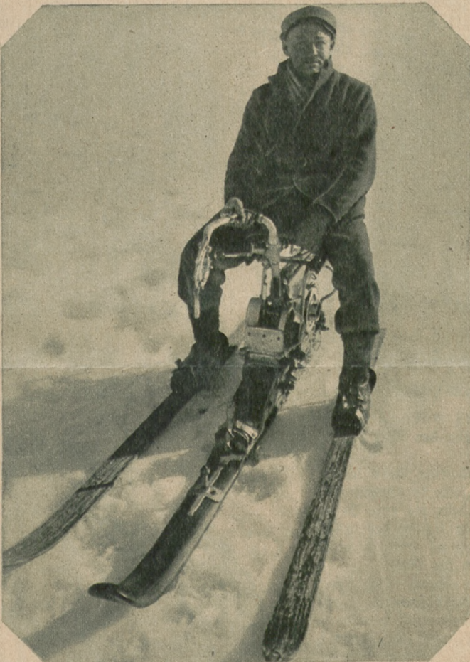
Zwei interessante Versuche, sich auf Schneeschuhen mit Motorenkraft fortzubewegen. Links: Ein kleiner Motor mit Propellerantrieb wird auf dem Rücken getragen. Oben: Der Motor, an dem ein Sitz angebracht ist, läuft auf einer Schiene zwischen den beiden angeschnallten Schneeschuhen
