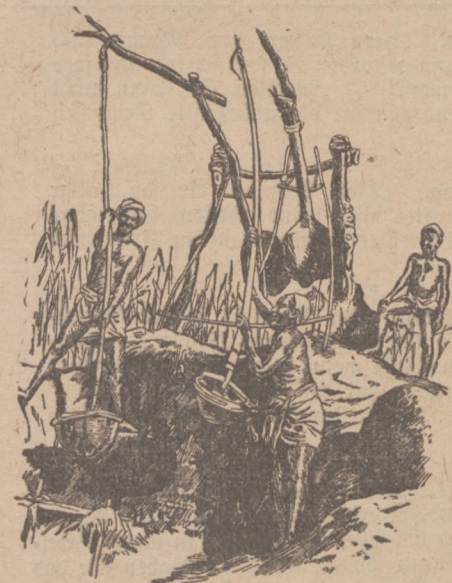
„Schaduf“, primitives ägyptisches Schöpfwerk.
