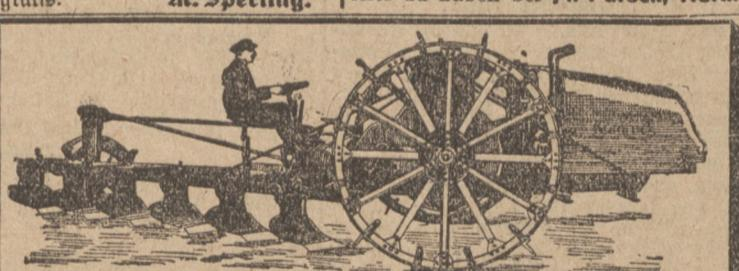
**Modell 1914 mit 3 Geschwindigkeiten, Rückwärtsgang u. mechanischer Aushebevorrichtung der Schare steht unbestreitbar an der Spitze aller Systeme.**
