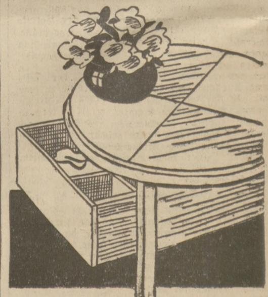
Bestimmung zugeführt werden. Man könnte beispielsweise einen großen tiefen Kasten unter seiner Platte anbringen lassen, der auf Schienen läuft.
