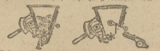
„Pöf“ zur Arbeit gestellt. „Pöf“ zwecks Reinigung und Entleerung geöffnet.
