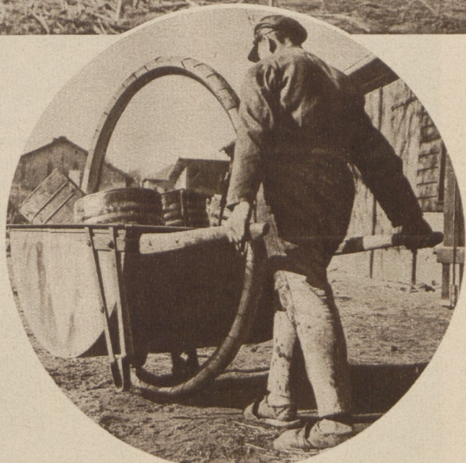
Ein Karren, dessen Kasten in einem Riesenrad hängt. Man kann damit ohne sonderliche Kraftaufwendung mehr als zwanzig Zentner fortzuschaffen.
