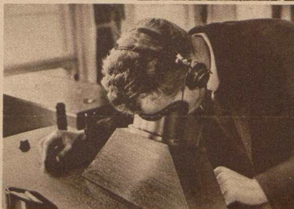
Zum präzisen Messen der Wellenlänge bedient man sich eines besonderen Apparates, in dem Sirenen aufglühen.
