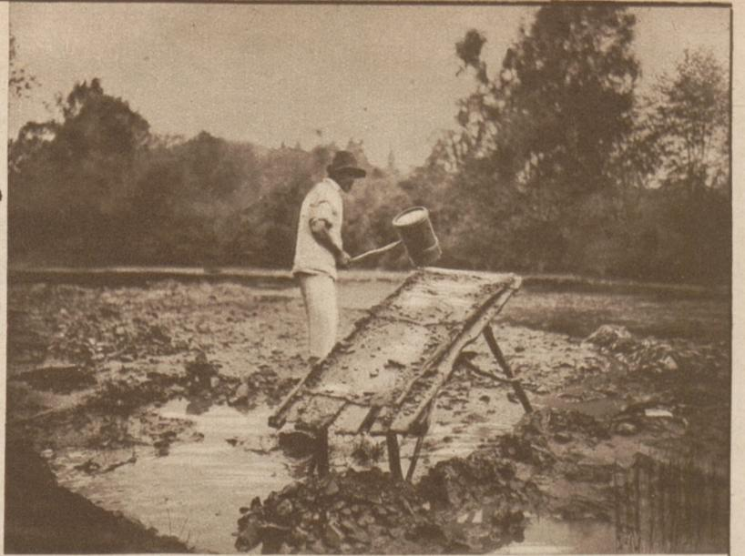
Das Auswaschen des Goldes aus dem Kiesel mittels der „Hurka“.
