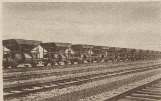
Ein Wagenzug Selbstentlader für die Anfuhr der Bettungs- stoffe.
