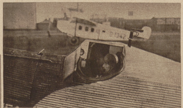
Vor der Nebelfahrt. Nur die eine Seite der Flugkabine, an der der Beobachter sitzt, ist offen; die andere, an der der Schüler Platz genommen hat, ist abgedeckt.
