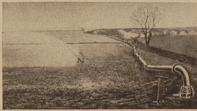
Unten: Feldberegnungsanlage mit Weitstrahlreglern; im Vordergrund rechts der Anschluß an festeingebautes Hydranten, im Anschluß daran die transportablen Schnellkupplungsrohre.
