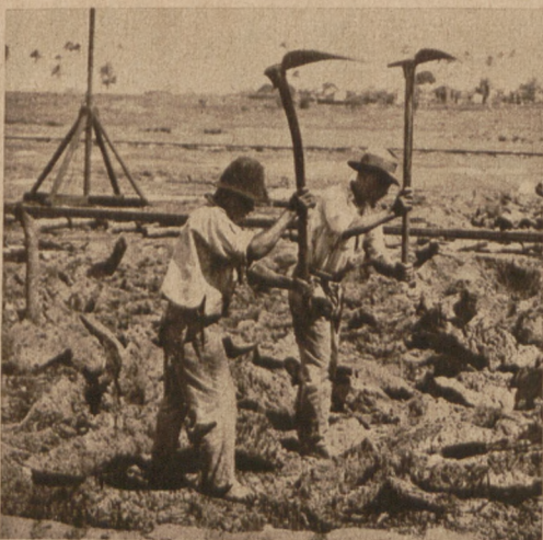
250 000 Tonnen Pech werden jährlich auf diese Weise „geerntet“. Das Material kann so einfach abgegraben und fortgeschafft werden.
