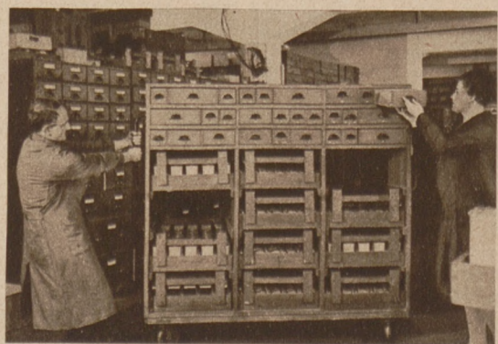
Der Serien-Wagen. Die in Teilarbeiten erzeugten Kamera-Bestandteile werden in einen Wagen zusammengeleht. Er enthält je 200 Stück. Im Montage-Saal am laufenden Band werden diese Teile zu 200 Kameras zusammengeleht.
