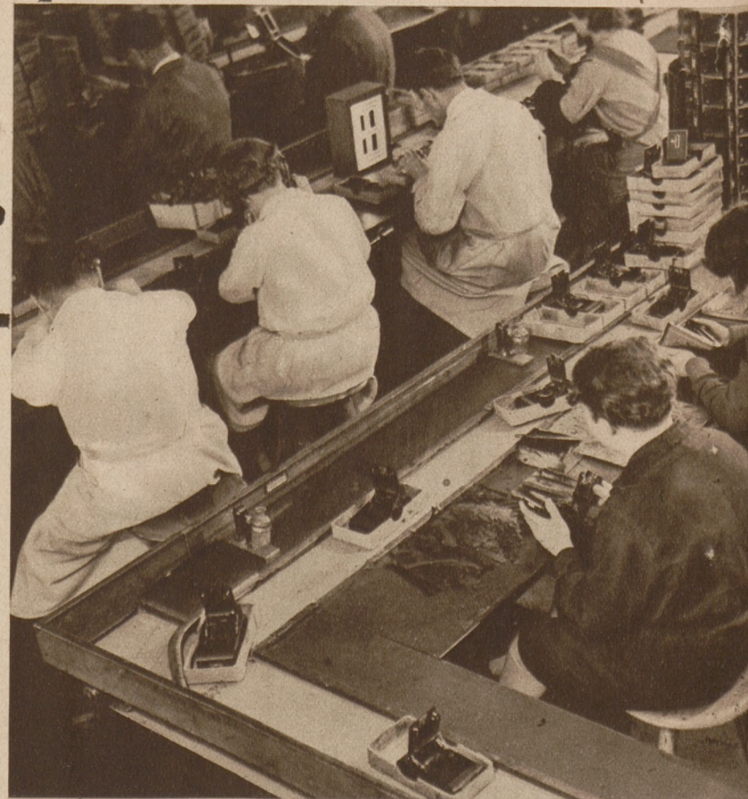
Ganz wie in der Automobil-Fabrik. Das laufende Band gleitet von Arbeitsplatz zu Arbeitsplatz. Jeder vollführt nur einen Handgriff. In 50 Minuten ist eine Agfa-Kamera zusammengeleht.
