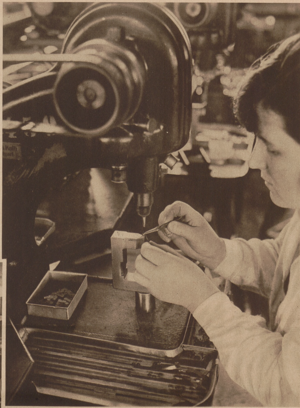
Hier nistet zarte Frauenhand. Der kleinste Niethammer der Welt nistet die einzelnen Kamerateile zusammen. Zum Teil ist die Arbeit so fein, daß die Pinzette beim Greifen zu Hilfe genommen werden muß.
