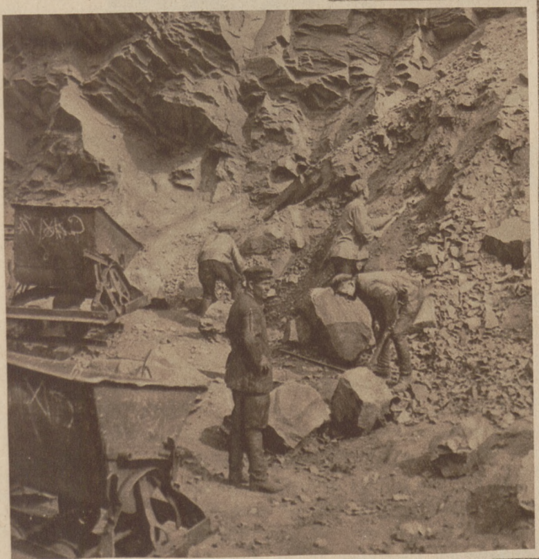
Wie im Steinbruch wird das durch Sprengungen geloderte Eisenerz mit Hade und Schaufel gesammelt.
