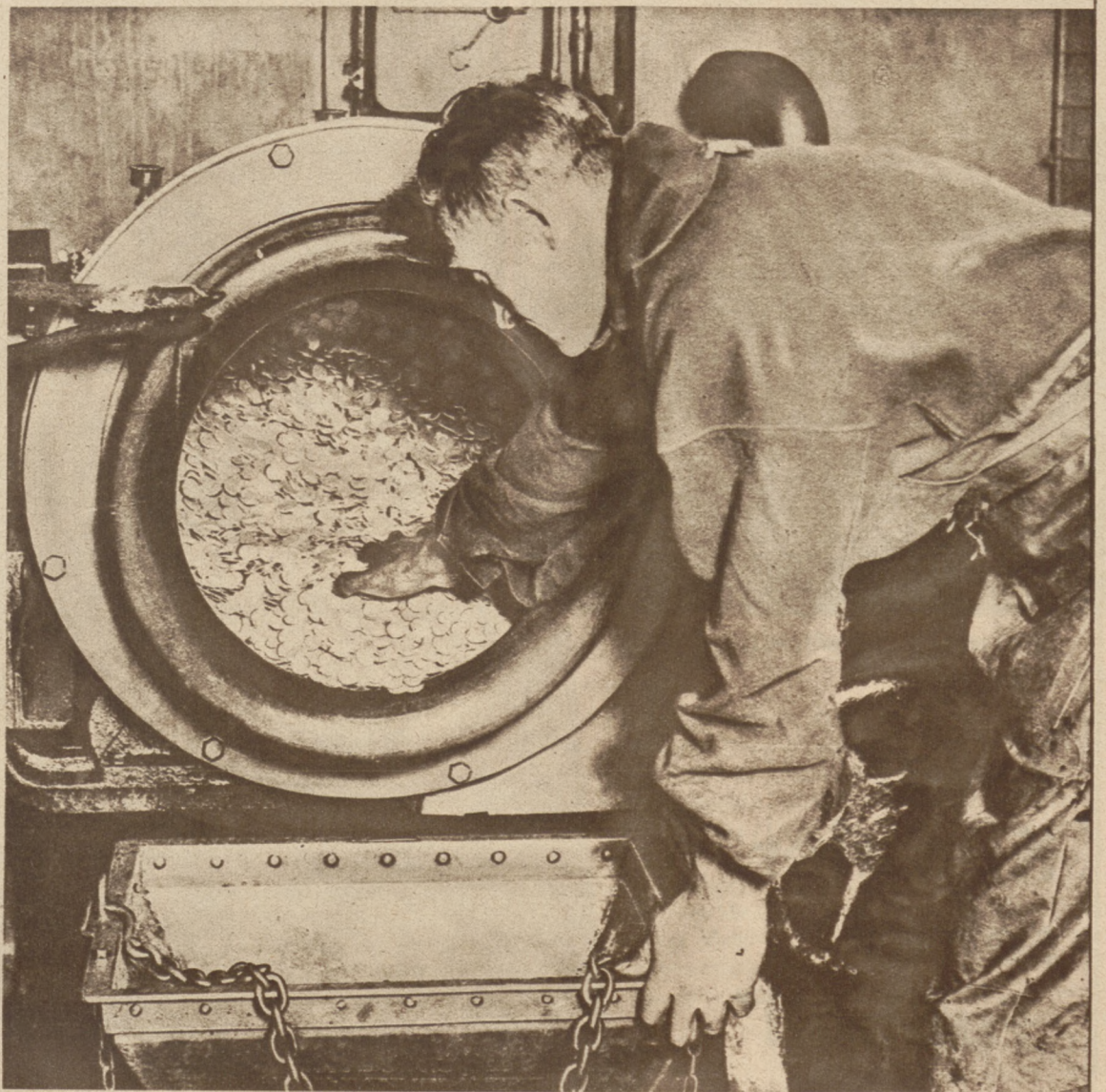
Silberstücke im rotierenden Schmelzofen.
