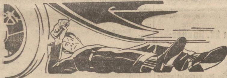
und in unbequemer Stellung mühevoll jede einzelne Chassis-Schmierstelle mit der Handpresse abschmieren —
